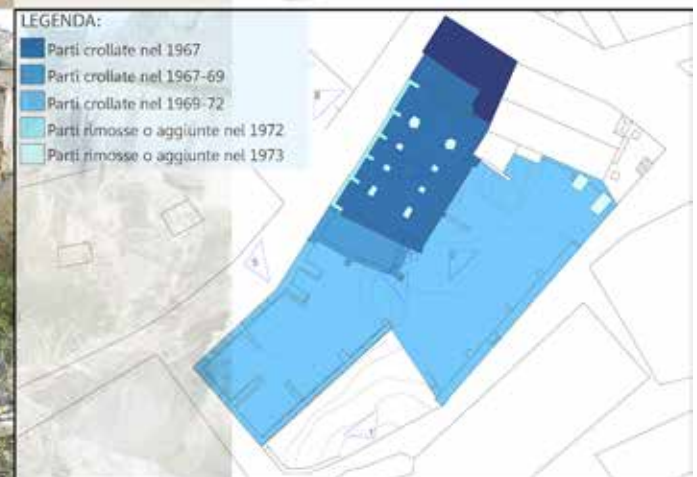
Fig. 1 Fotografie dello stato di fatto e stratigrafie delle principali fasi di costruzione e demolizione
