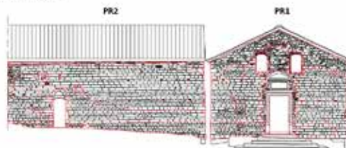
prospetti esterni rilievo stratigrafico
