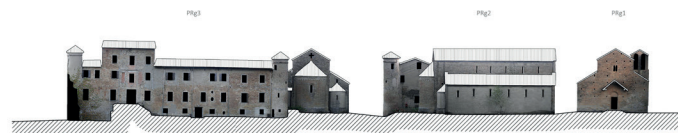
Prospetti esterni rilievo fotogrammetrico
