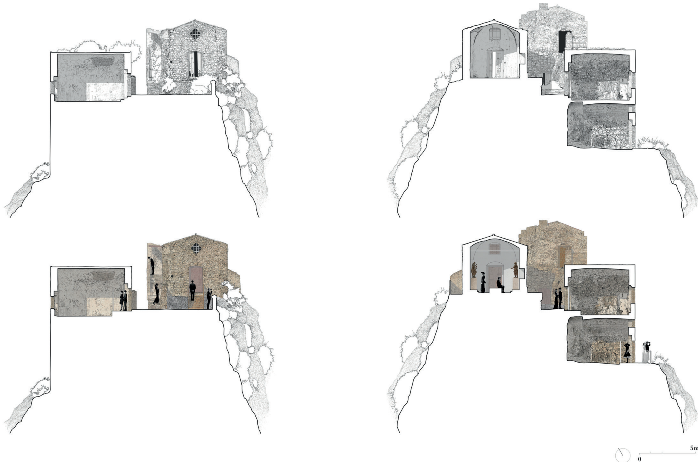
Fig. 7 Alzati della cappella di santa Barbara e di via Alfieri: rilievo architettonico (prospetto-sezione A-A' in alto a sinistra e sezione B-B' in alto a destra) e progetto di restauro (prospetto-sezione A-A' in basso a sinistra e sezione B-B' in basso a destra) (elaborazione grafica: S. Belmondo, M.A. Catella, M. Intini, M. Madio, G. S. Orofino, P. Vitucci, 2015; M.A. Catella 2016)
