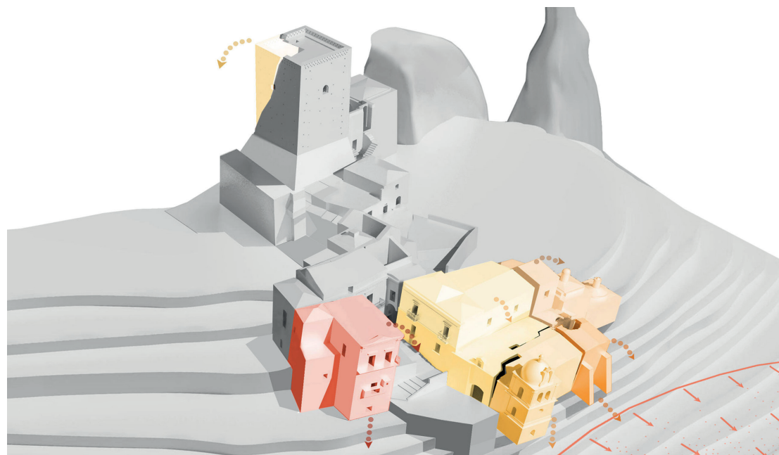
Fig. 5 Chiesa madre di san Nicola Vescovo: restituzione assonometrica dei meccanismi di collasso (elaborazione grafica: C. Bisceglia, C. R. Calitro, P. Colonna, A. D'Ercole, M. Pepe, A. Santarcangelo, 2014)
