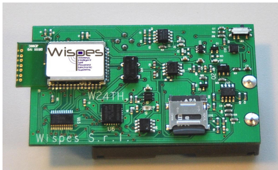
Fig. 15 - Datalogger wireless con sensori di temperatura, umidità, vibrazione, luminosità.
